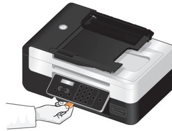
Pomocí oranžového pásku zvedněte ovládací panel tak, až zaklapne na místo. Pásek odstraňte a vyhodte.
