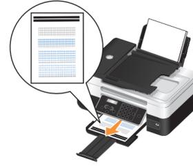
Zavřete jednotku tiskárny. Automaticky se vytiskne stránka vyrovnání. Stránku vyrovnání po vytištění zlikvidujte.
