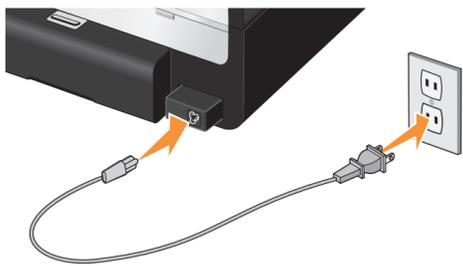
Připojte napájecí kabel ke zdroji napájení na zadní straně tiskárny, a poté zapojte napájecí kabel do zásuvky ve zdi.
