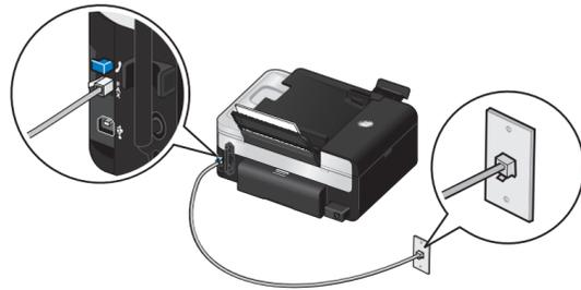
Pro odesílání a příjem faxů připojte funkční telefonní linku do konektoru FAX (F). Pokud používáte u počítače DSL modem, musíte nainstalovat filtr DSL. Potřebujete-li pomoc, obraťte se na svého poskytovatele služeb DSL.
