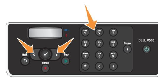
Pomocí tlačítek se šipkou a klávesnice zadejte jazyk, zemi, datum, čas, faxové číslo a název faxu. Každé nastavení uložte stisknutím tlačítka **Výběr** (V). Pokud potřebujete obnovit jazyk, podržte při zapnutí tiskárny stisknutá tlačítka **Zpět** (S) a **Start** (O).
