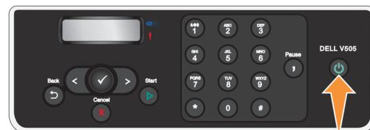
Zapněte tiskárnu tlačítkem **Napájení** na ovládacím panelu.
