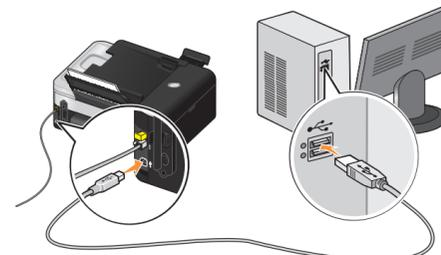
Pomocí kabelu USB (prodává se samostatně) připojte počítač k portu USB na zadní straně tiskárny. Pokud se zobrazí okno **Nalezen nový hardware**, klepněte na tlačítko **Storno**.
